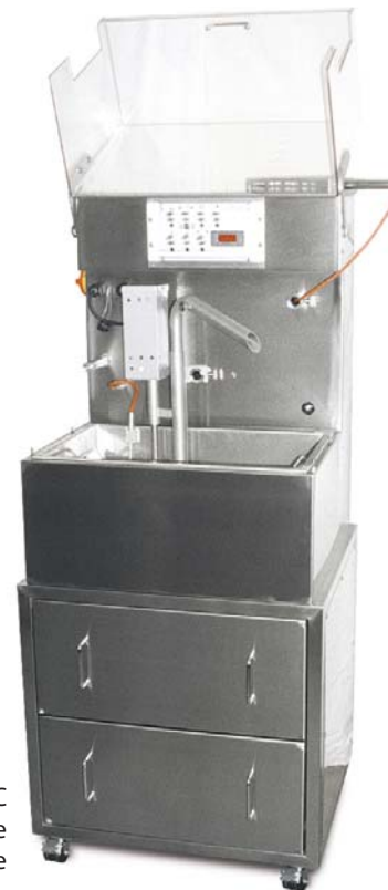
LCM 180 C fonctionnant comme une mouleuse
